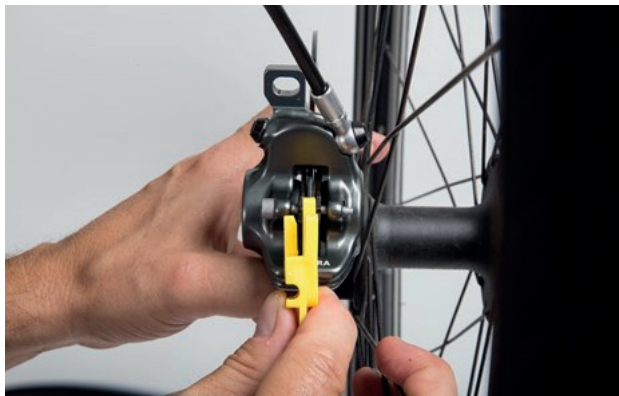
Abbildung 118: Bremsbelag im eingebauten Zustand mithilfe der Transportsicherung prüfen
