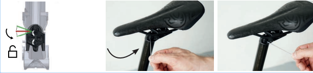
Abbildung 128: Höhenverstellungsbetätigung in „Geöffnete Stellung“ bringen
