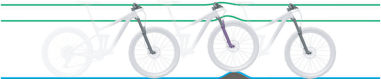
Abbildung 10: Optimales Fahrverhalten der Gabel bei Unebenheiten
