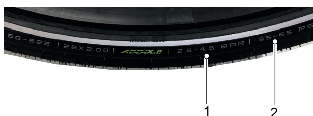
Abbildung 115: Fülldruck in bar (1) und psi (2)
