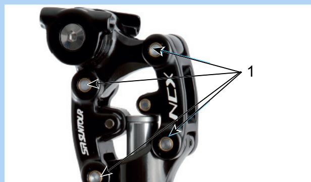
Abbildung 127: Schmierpunkte SR Suntour Feder-Sattelstütze
