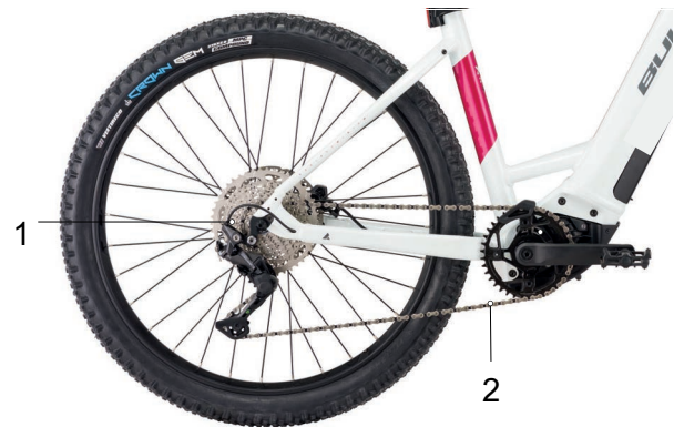
Abbildung 26: Schema Kettenantrieb mit Kettenschaltung
