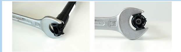
Abbildung 149: Gegen Verdrehen sichern
