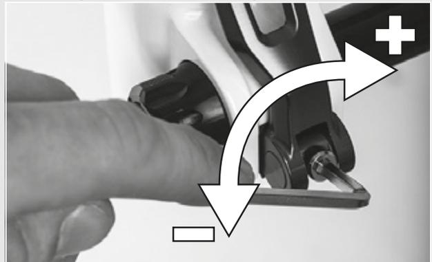
Figura 47: Ajuste de la fuerza de tensado del cierre rápido
