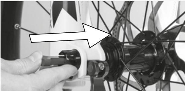
Figura 44: Inserción de la palanca de cierre rápido en el eje
