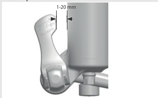
Figura 53: Distancia desde la palanca al brazo de la horquilla
