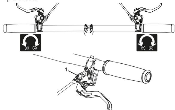
Figura 64: Utilización del botón giratorio (1) para el ajuste del punto de presión
