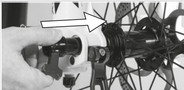
Figura 42: Inserción del eje en el buje
