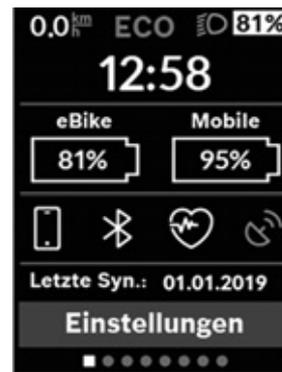
En la PANT. ESTADO se muestran la hora actual, el estado de carga de todas las baterías del S-Pedelec (eBike) y el estado de carga de las baterías del smartphone (teléfono móvil) debajo de la barra de estado si el smartphone está conectado a través de Bluetooth®.
