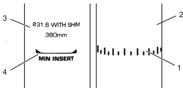
Figura 59: Vista detallada de las tijas de sillín, ejemplos de las marcas de la profundidad de inserción mínima
