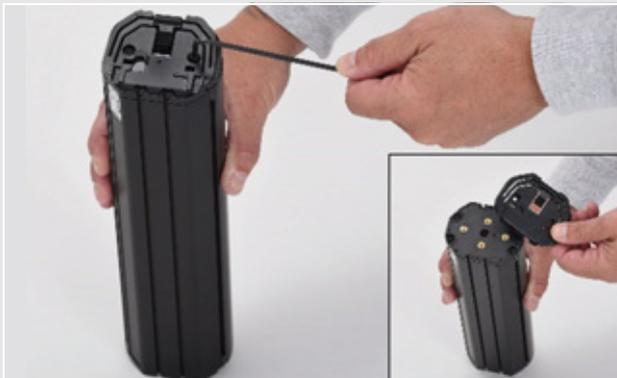
Figura 32: Desmontaje de la interfaz superior
