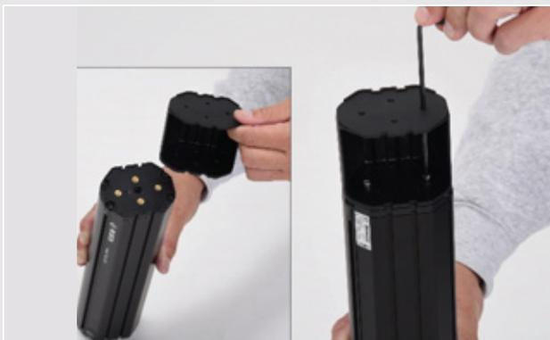
Figura 33: Montaje de la prolongación de la PowerTube
