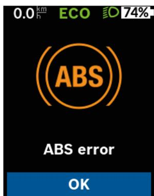
Figura 18: Mensaje de error del ABS en la pantalla Kiox
