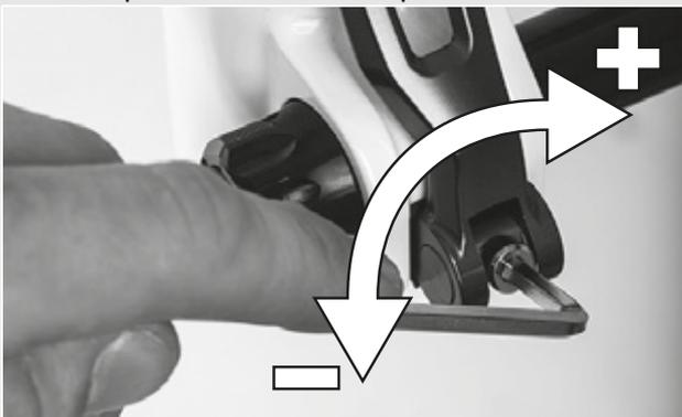
Figura 92: Ajuste de la fuerza de tensado del cierre rápido
