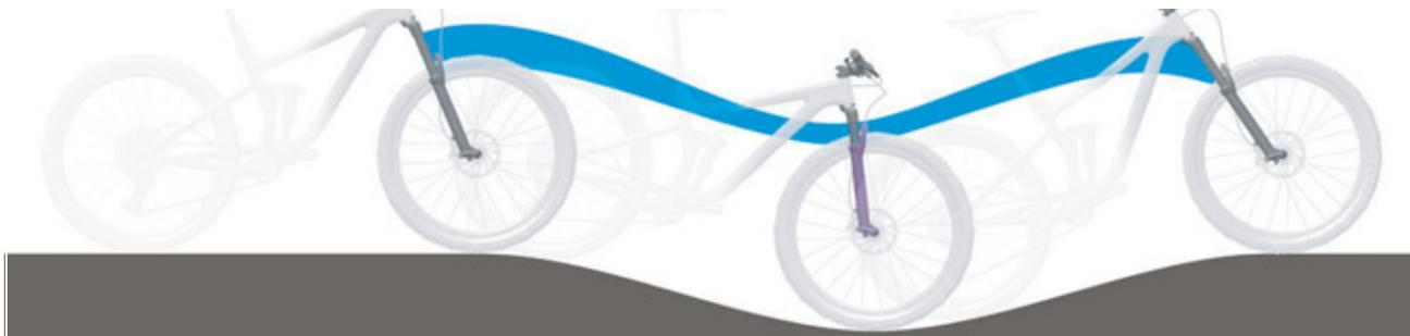
Figura 97: Suspensión de la horquilla de suspensión demasiado blanda en montaña
