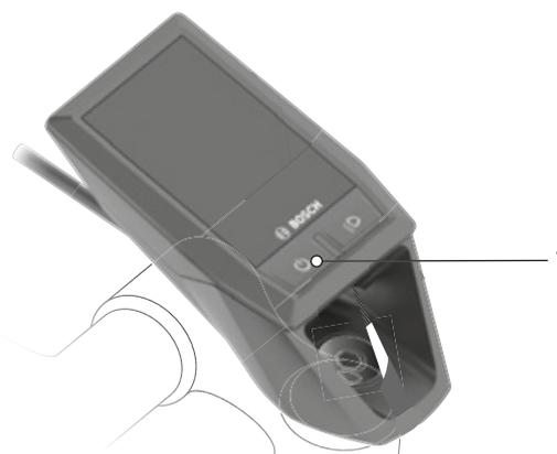
Figura 77: Posición del botón de conexión/desconexión (ordenador de a bordo)
