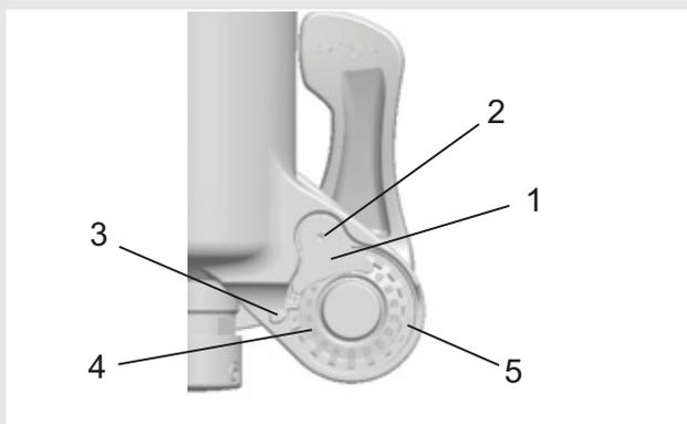
Figura 54: Estructura del cierre rápido desde atrás con (1) seguro de la tuerca de eje y (5) tuerca de eje
