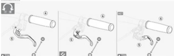
Figura 63: Ajustar el ancho de agarre de la palanca de freno con freno de disco Magura
