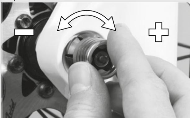
Figura 50: Ajuste de la tensión
