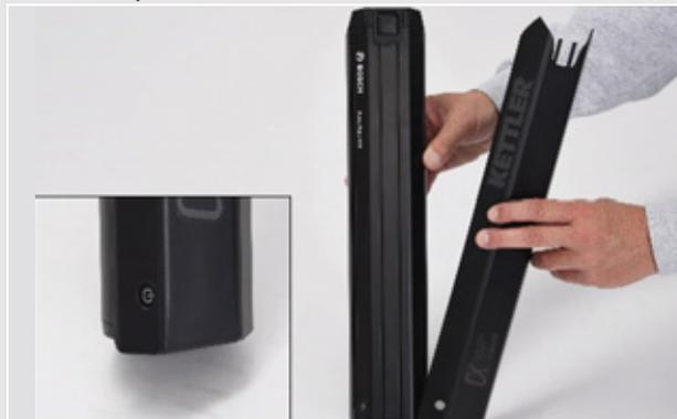
Figura 31: Desplazamiento de la cubierta de la batería sobre la batería
