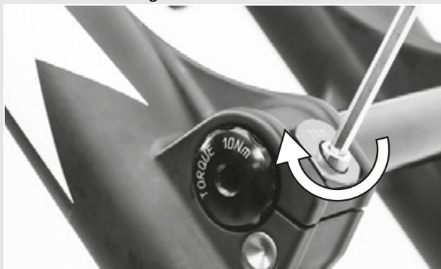
Figura 41: Apretar la abrazadera de sujeción
