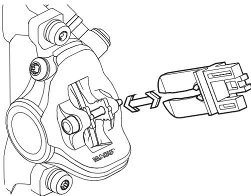
Figura 22: Fijación del seguro de transporte
