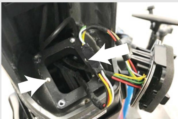
Figura 28: Apriete del soporte del adaptador
