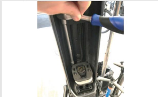
Figura 25: Retirada de los tornillos de hexágono interior
