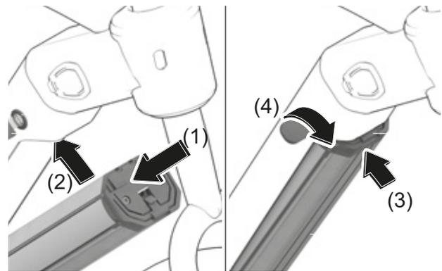
Figura 70: Inserción de la batería integrada
