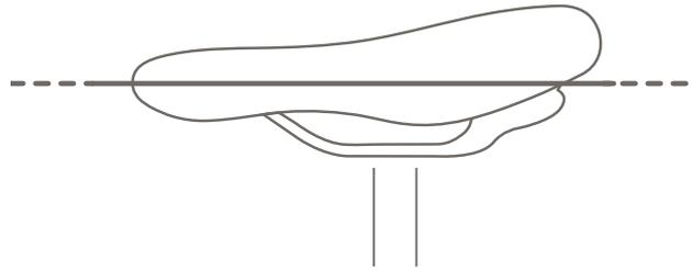
Figura 56: Inclinación horizontal del sillín
