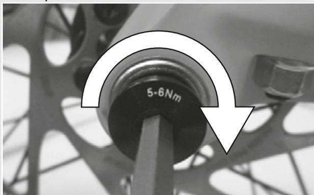
Figura 39: Apriete del tornillo de seguridad
