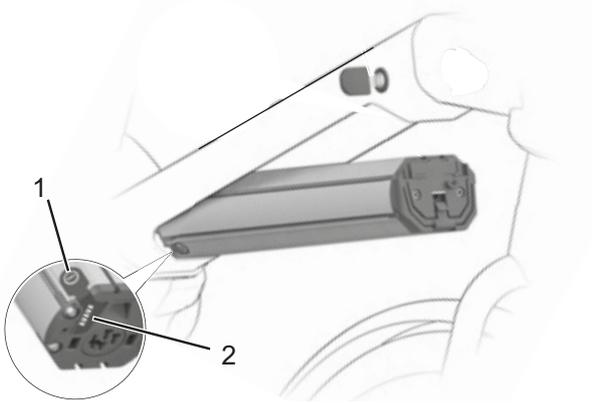
Figura 21: Ejemplo de indicador de carga
