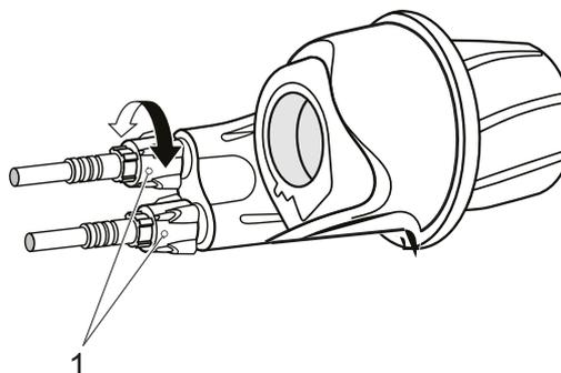
Figura 89: Puño giratorio con tornillo de ajuste (1)
