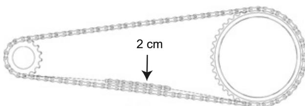
Figura 88: Comprobación de la tensión de la cadena
