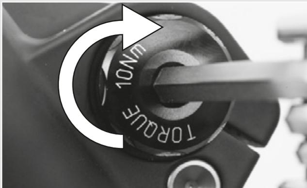
Figura 40: Apriete del eje insertado
