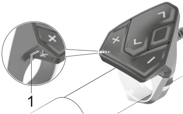
Figura 79: Posición del botón de ayuda para el desplazamiento en el elemento de mando
