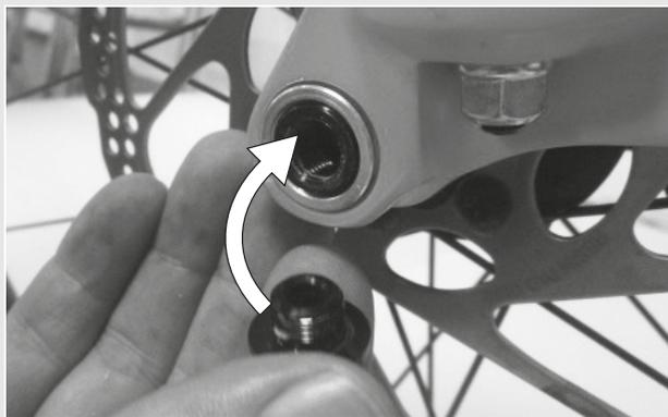
Figura 38: Inserción de la palanca de cierre rápido en el eje
