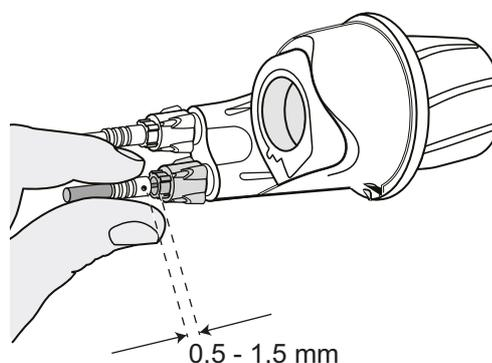
Figura 90: Puño giratorio con tornillo de ajuste (1)
