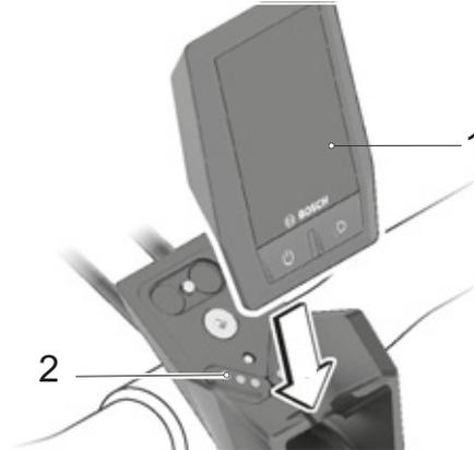
Figura 73: Colocación del ordenador de a bordo (1)
