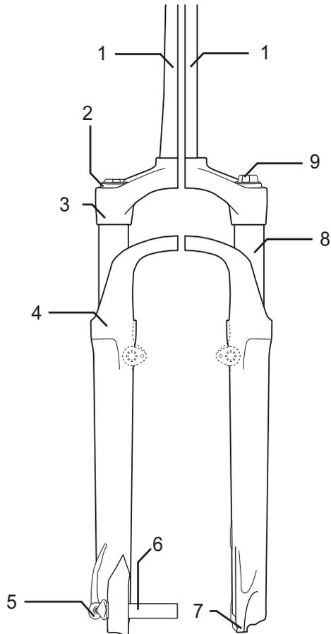
**Figura 7: Ejemplo de horquilla Suntour**
