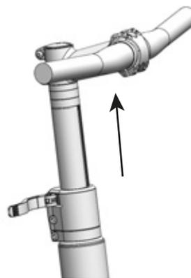
Figura 62: Movimiento hacia arriba de la palanca de seguridad, ejemplo All Up
