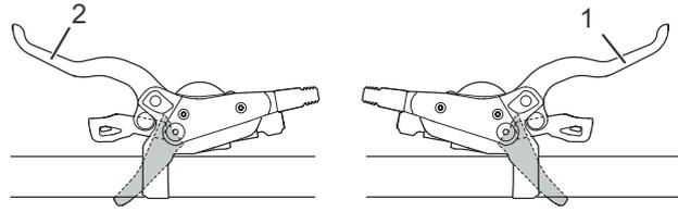
Figura 83: Palanca de freno trasero (1) y delantero (2), ejemplo freno Shimano
