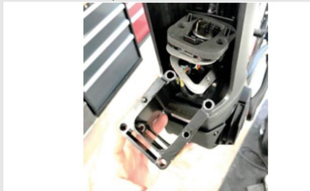
Figura 26: Extracción del adaptador PowerTube
