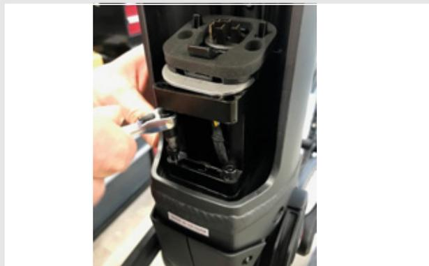
Figura 24: Retirada de los tornillos hexagonales de 4 mm
