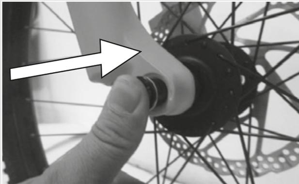
Figura 36: Inserción completa del eje
