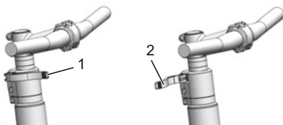
Figura 61: Palanca tensora de la potencia cerrada (1) y abierta (2), ejemplo All Up
