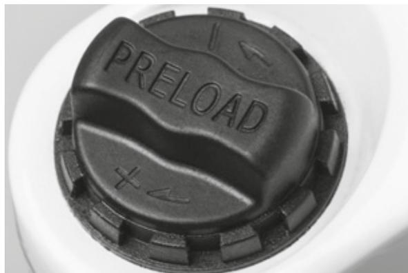
Figura 65: Rueda de ajuste SAG en la corona de la horquilla de suspensión
