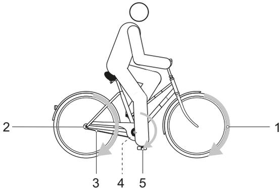
Figura 10: Esquema del sistema de accionamiento mecánico
