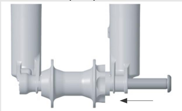
Figura 55: Inserción del eje Kabolt
