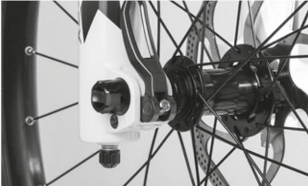
Figura 91: Ajuste de la fuerza de tensado del cierre rápido
