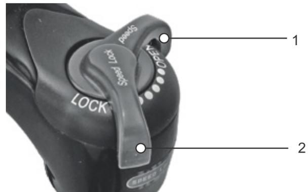
Figura 86: Amortiguador de niveles de presión Suntour en posición abierta (1) y cerrada (2)
