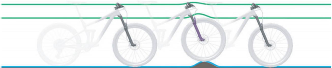
**Figura 6: Condición óptima de marcha de la horquilla en caso de irregularidades**
