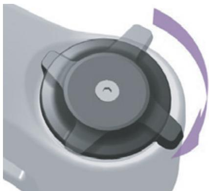
Figura 98: Ajuste para un regulador de niveles de presión más duro
