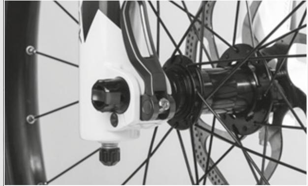
Figura 46: Posición perfecta de la palanca tensora
