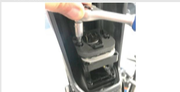
Figura 23: Aflojamiento de los tornillos del soporte del adaptador
