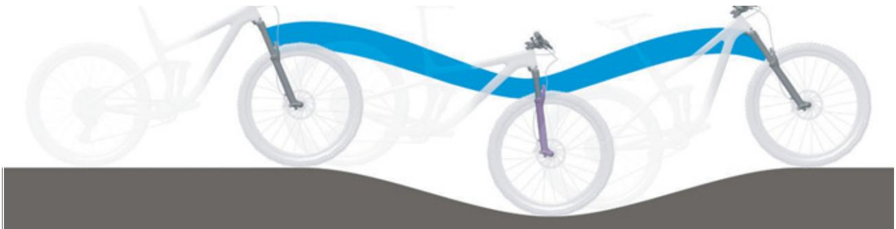
**Figura 5: Condición óptima de marcha de la horquilla sobre un terreno accidentado**
