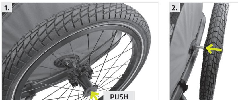
Achten Sie bei der Montage des Anhängers darauf, dass die Räder korrekt und sicher montiert sind. Wenn Sie mit dem Typ der Räder, die an diesem Anhänger verwendet werden, nicht vertraut sind, wenden Sie sich an Ihren Händler, um eine Einweisung in die korrekte Bedienung dieser Räder zu erhalten. Verwenden Sie nur Reifen mit Straßenprofil und nicht mit BMX- oder Knobbyprofil.
