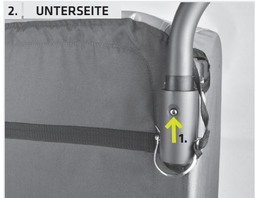
Zum Entfernen der Deichsel lösen Sie zuerst den QR-Bügel und den Kupplungsverbindungsstift. Drücken Sie dann den silbernen Metallstift (Abb. 2.|1.) um die Deichsel aus der Halterung zu ziehen.
