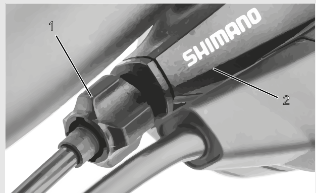
Illustration 35 : Douille de réglage (1) du changement de vitesse à un câble actionné par câble avec boîtier de manette de vitesse (2), exemple
