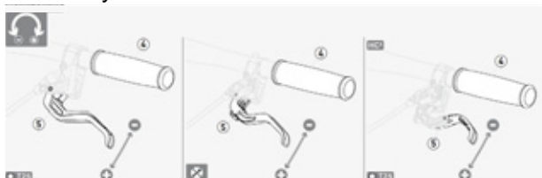
Illustration 19 : Régler la garde d'un levier de frein à disque Magura
