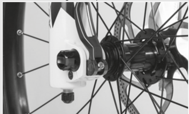
Illustration 41 : Régler la force de serrage de l'attache rapide
