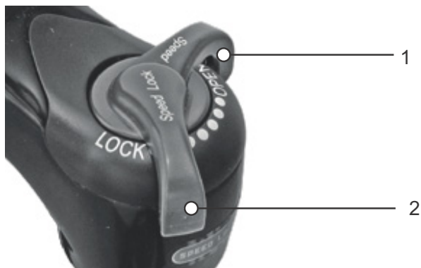
Illustration 38 : Dispositif de réglage de la compression Suntour avec les positions OPEN (1) et LOCK (2)
