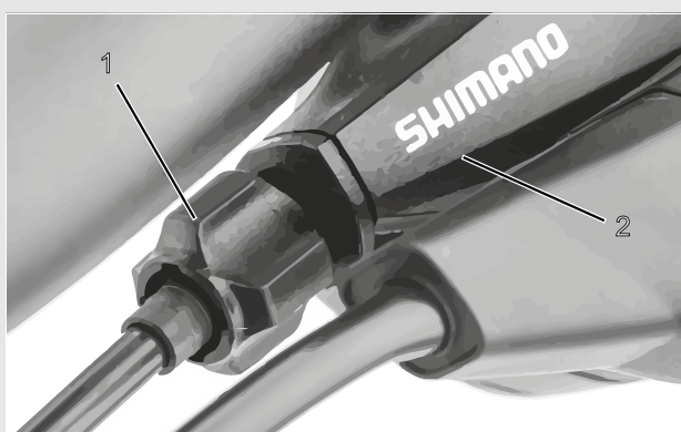
Illustration 43 : Douille de réglage (1) du changement de vitesse à un câble actionné par câble avec boîtier de manette de vitesse (2), exemple
