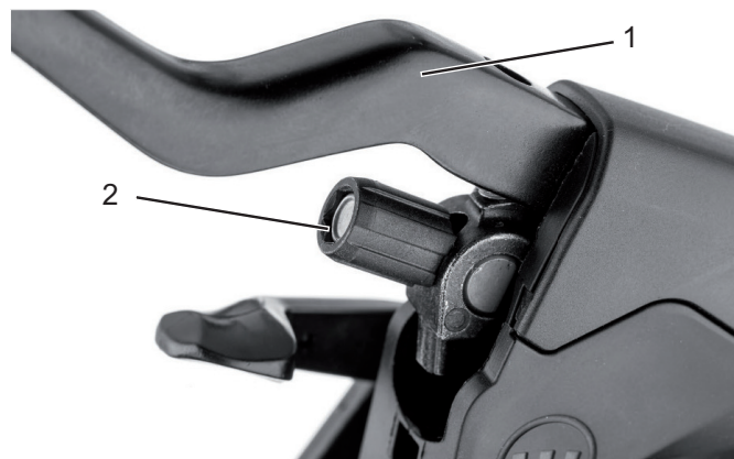
Abbildung 65: Bremshebel (1) der hydraulisch betätigten Felgenbremse mit Einstellschraube (2)
