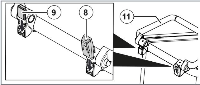
Abbildung 9: Rücklicht und Reflektor einsetzen
