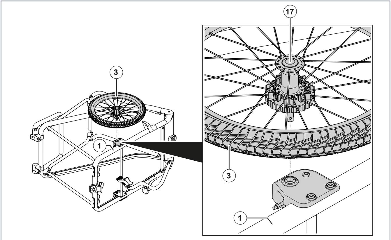
Abbildung 7: Laufräder montieren
