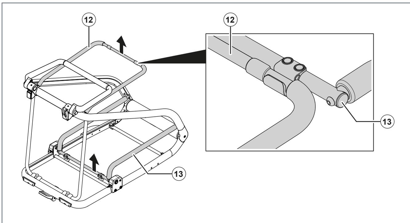
Abbildung 5: Dachbügel und vorderen Bügel ausklappen
