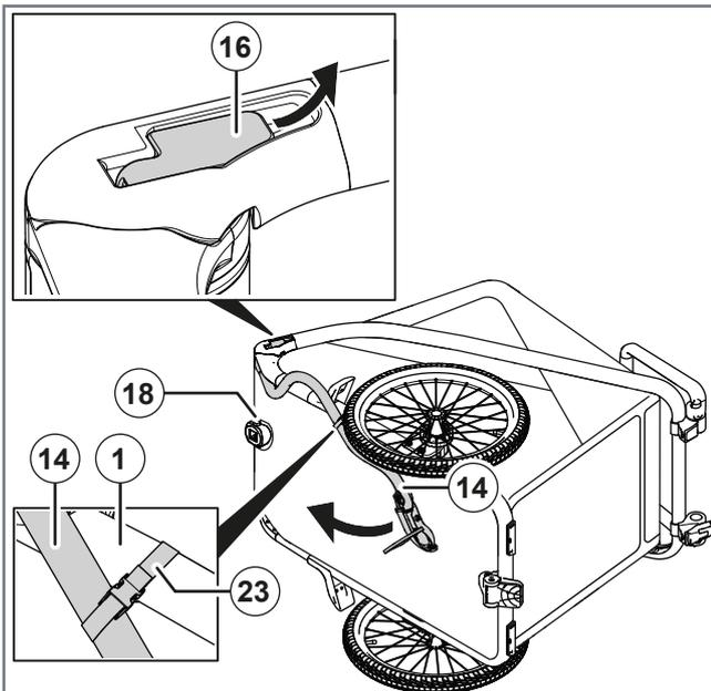
Abbildung 10: Deichsel ausklappen
