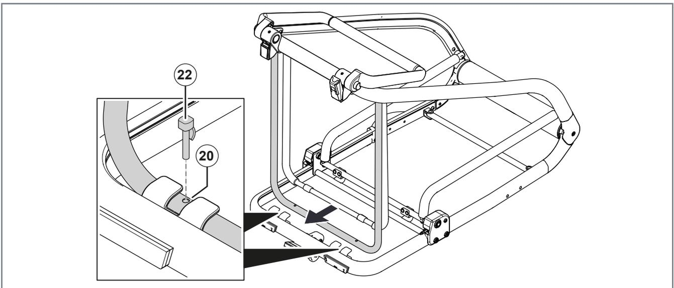
Abbildung 4: Hinteren Bügel ausklappen und fixieren
