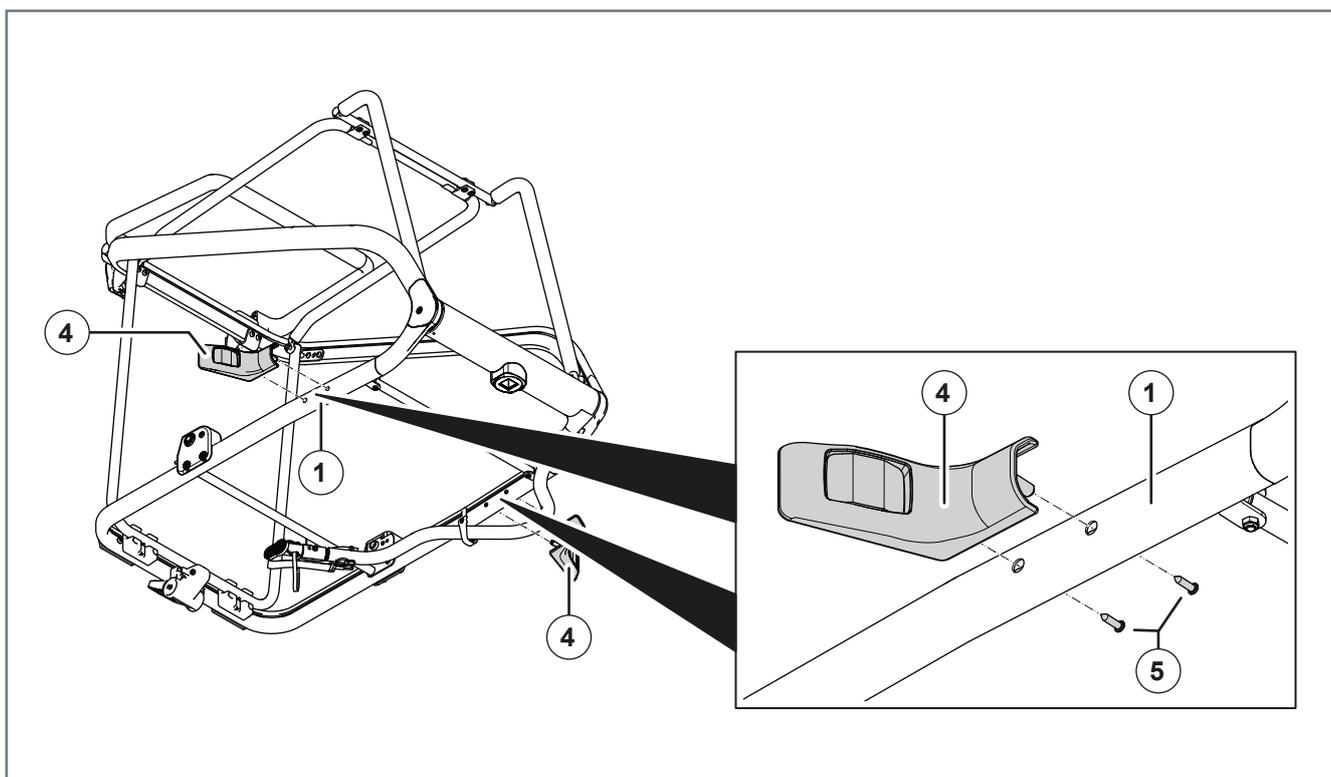
Abbildung 6: Radschützer montieren
