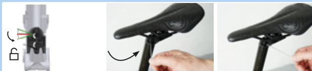
Afbeelding 159: Bediening hoogteverstelling in stand "geopend" zetten
