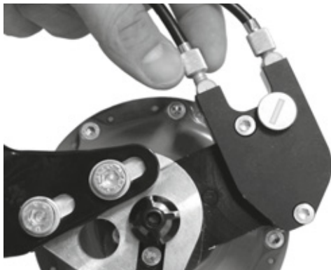
Afbeelding 152: Bij Rohloff naafversies met externe schakelaansturing zit de kabelafsteller op de kabelbox aan de linkerkant.
