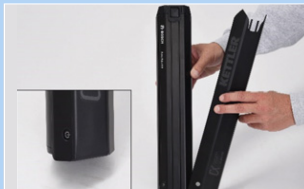
Afbeelding 61: Accuafdekking op de accu schuiven
