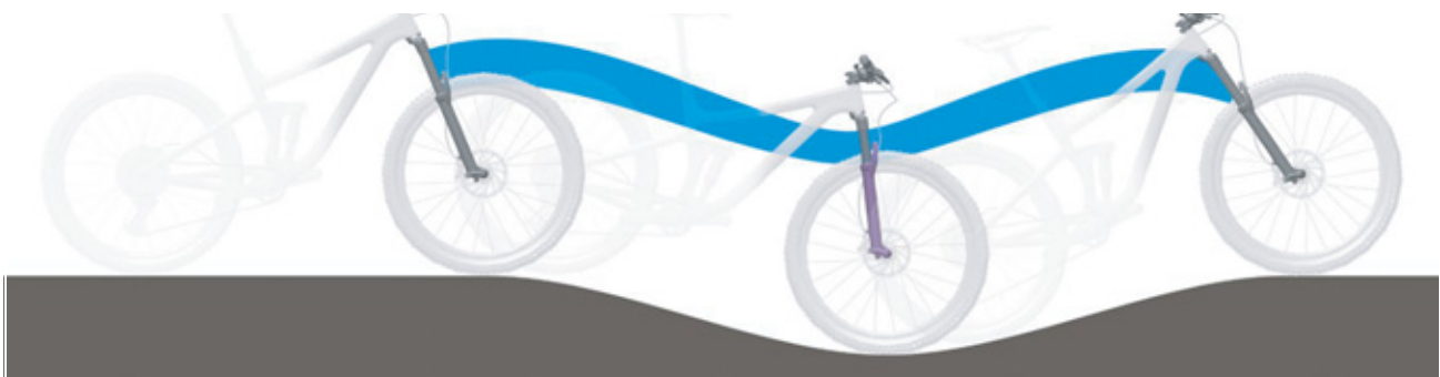
Afbeelding 9: Optimaal rijgedrag van de vork in heuvelachtig terrein
