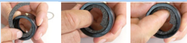
Afbeelding 207: Vilten ring inleggen
