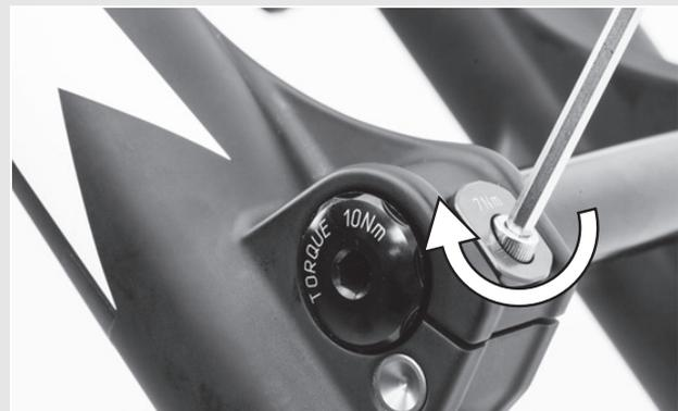
Abbildung 53: Sicherheitsklemme anziehen
