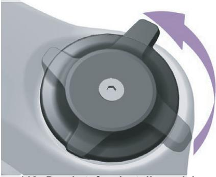
Abbildung 118: Druckstufeneinsteller weicher einstellen
