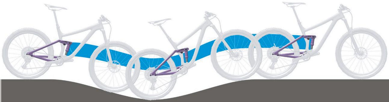
Abbildung 92: Optimales Fahrverhalten des Hinterbau-Dämpfers im hügeligen Gelände
