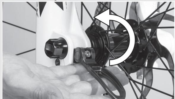
Abbildung 57: Hebel sichern
