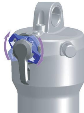
Abbildung 95: Druckstufeneinsteller härter einstellen
