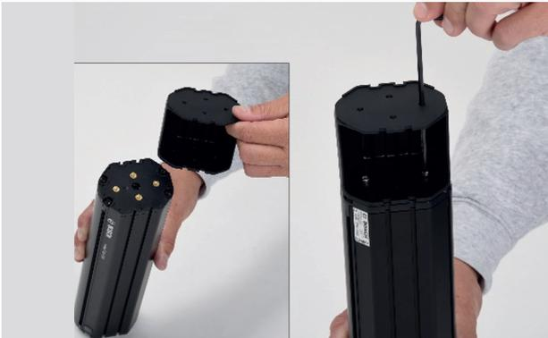
Abbildung 45: PowerTube EVerlängerung montieren
