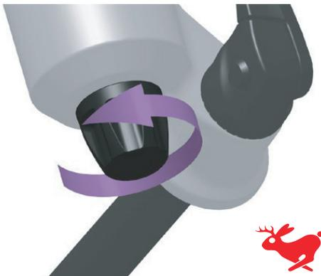
Abbildung 131: Zugstufendämpfer in Richtung Hase drehen
