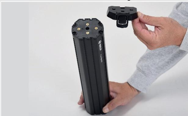
Abbildung 42: Montageplatte montieren
