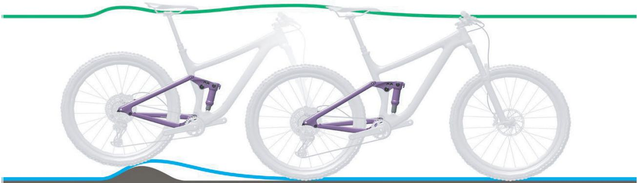
Abbildung 142: Zu harte Dämpfung des Hinterbau-Dämpfers bei Unebenheiten
