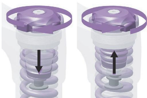
Abbildung 79: Vorspannungseinstellung herein und heraus drehen.
