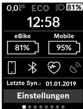
Auf der STATUSSEITE werden unter der Statusleiste die aktuelle Uhrzeit, der Ladezustand aller Akkus des Pedelecs (eBike) und der Ladezustand des Smartphone-Akkus (Mobile) angezeigt, wenn das Smartphone über Bluetooth® verbunden ist.
