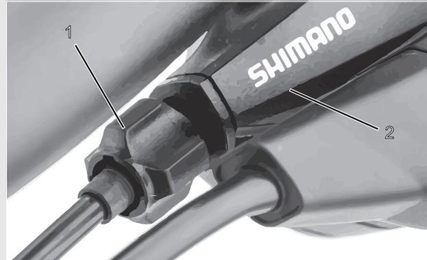
Abbildung 125: Einstellhülse (1) der einzügigen, seilzugbetätigten Gangschaltung mit Schalthebelgehäuse (2), Beispiel
