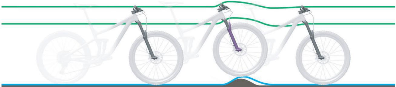
Abbildung 134: Zu harte Dämpfung der Federgabel bei Unebenheiten
