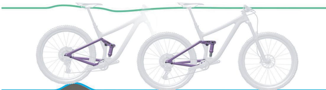
Abbildung 12: Optimales Fahrverhalten des Hinterbau-Dämpfers bei Unebenheiten
