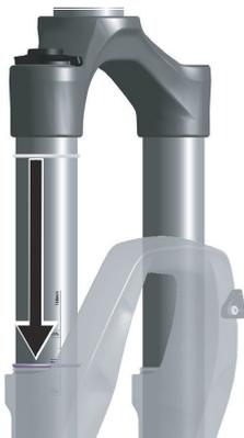
Abbildung 81: O-Ring an der Federgabel verschieben
