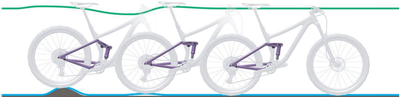
Abbildung 136: Zu schnelles Ausfedern des Hinterbau-Dämpfers
