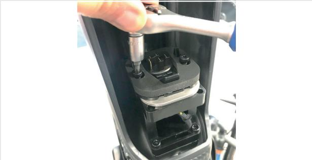
Abbildung 35: Akkuhalter Schrauben lösen
