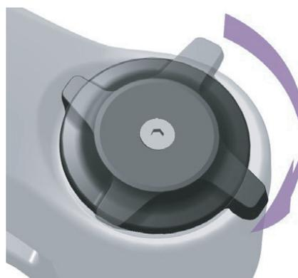
Abbildung 117: Druckstufeneinsteller härter einstellen
