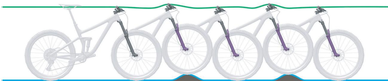
Abbildung 85: Optimales Fahrverhalten der Gabel
