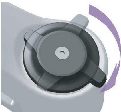
Abbildung 133: Druckstufeneinsteller härter einstellen
