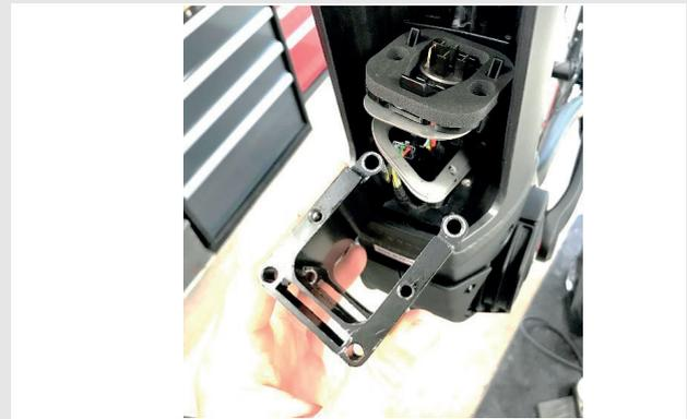
Abbildung 38: PowerTube Adapter herausziehen
