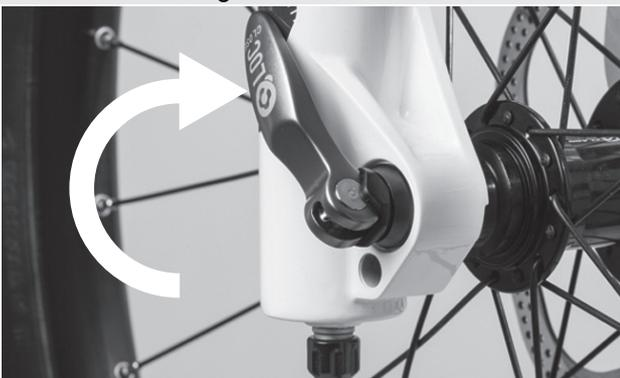
Abbildung 63: Schnellspanner schließen
