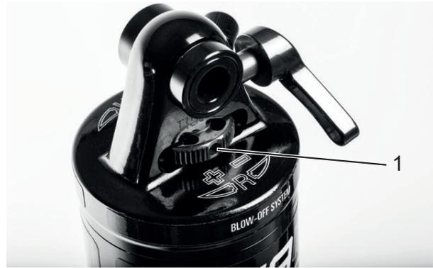
Abbildung 88: Suntour-Zugstufeneinsteller Rad (1) am Hinterbau-Dämpfer
