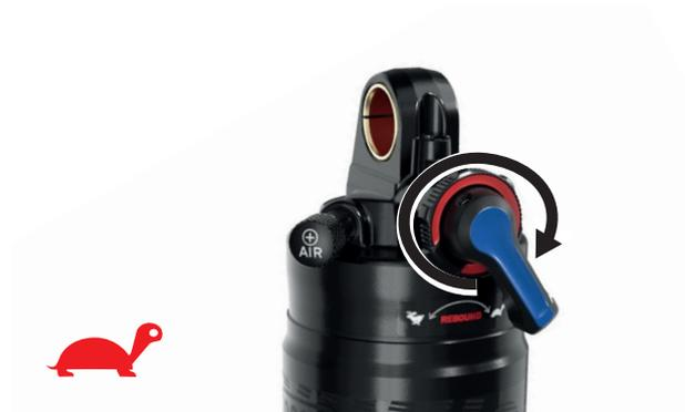
Abbildung 90: Ausfedergeschwindigkeit verringern
