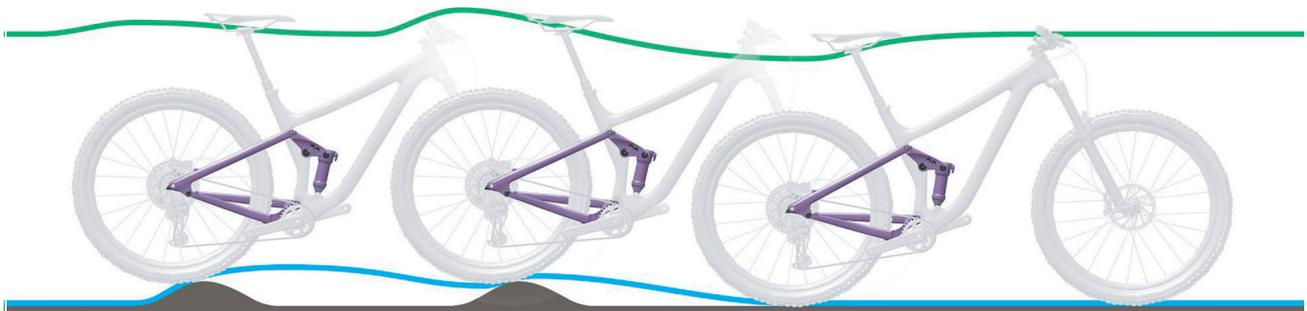
Abbildung 138: Zu langsames Ausfedern des Hinterbau-Dämpfers
