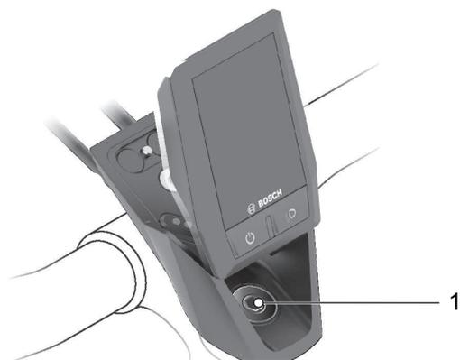
Abbildung 105:Lage Steuersatzschraube
