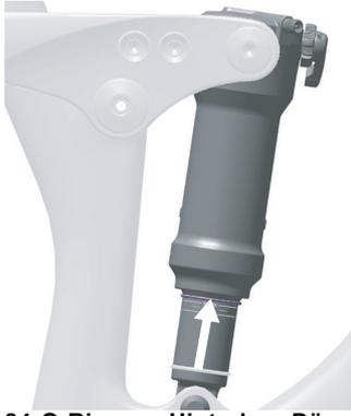
**Abbildung 84: O-Ring am Hinterbau-Dämpfer verschieben**
