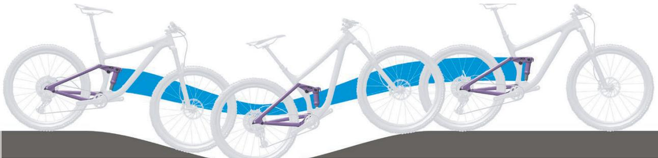
Abbildung 140: Zu weiche Federung des Hintebau-Dämpfers am Berg
