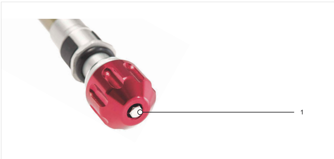
Illustration 208 : Exemple d'un réglage de détente SR SUNTOUR (fourche) (1)
