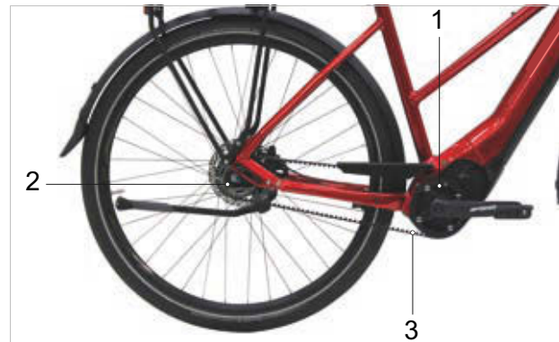
Illustration 43 : Schéma de l'entraînement à courroie
