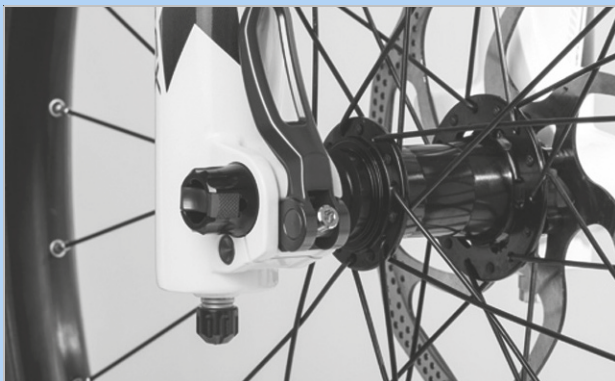
Illustration 79 : Position parfaite du levier de serrage
