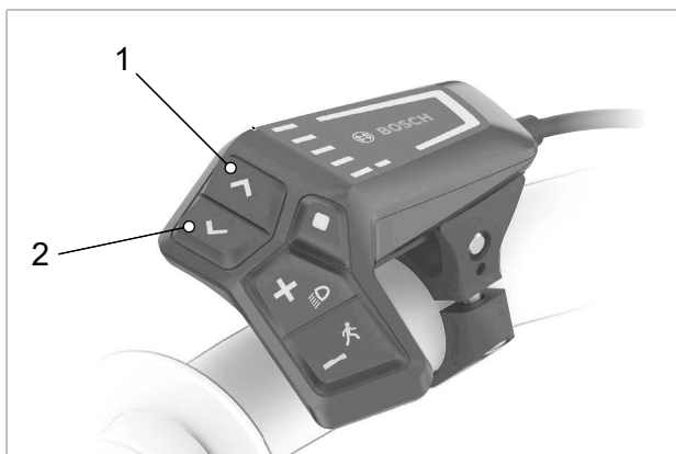
Illustration 155 : Position de la touche d'augmentation de la luminosité (2) et de la touche de réduction de la luminosité (1)
