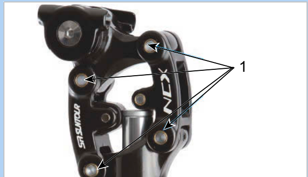
Illustration 205 : Points de lubrification de la tige de selle suspendue SR SUNTOUR
