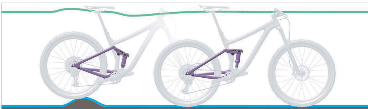
Afbeelding 127: Optimaal rijgedrag van de achterbouwdemper bij oneffenheden
