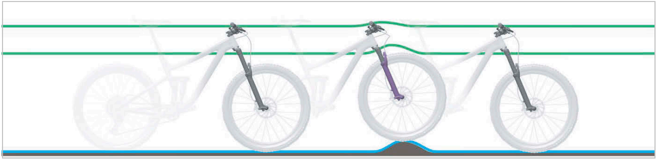
Afbeelding 20: Optimaal rijgedrag van de verende voorvork bij oneffenheden
