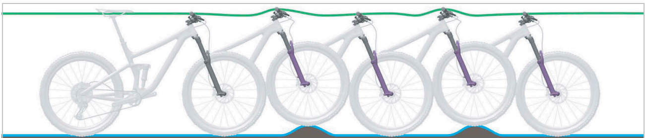
Afbeelding 21: Optimaal rijgedrag van de verende voorvork
