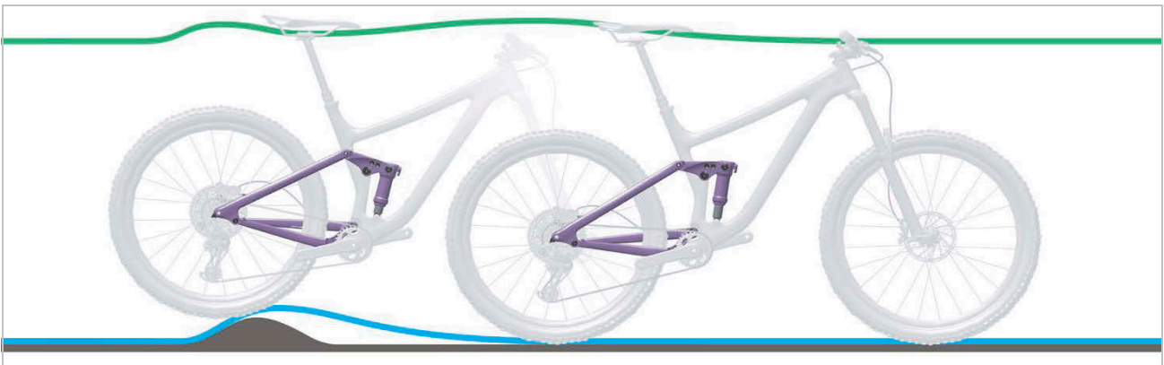
Afbeelding 211: Te harde demping van de achterbouwdemper bij oneffenheden
