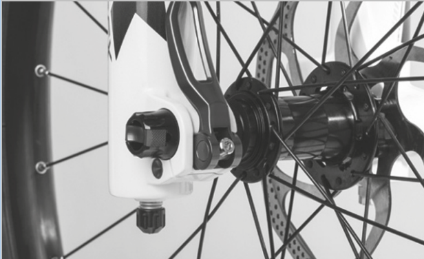
Afbeelding 194: Spankracht van de snelspanner afstellen
