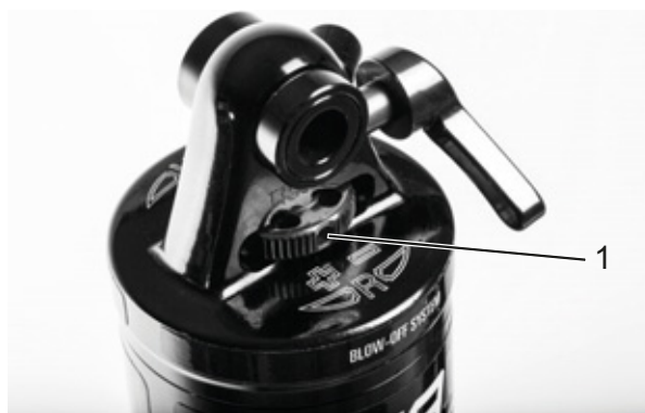
Illustration 62 : Molette de réglage de la détente Suntour (1) sur l'amortisseur arrière
