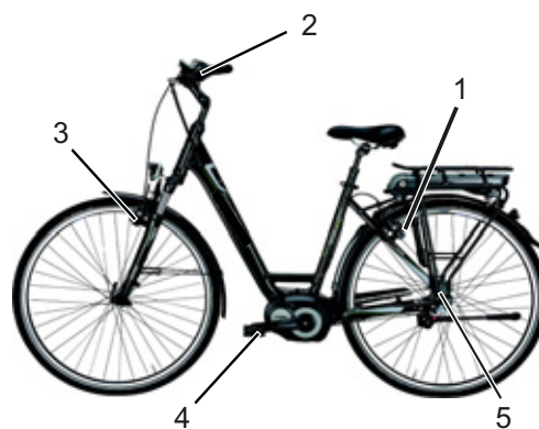
Illustration 12 : Système de frein d'un vélo électrique avec un frein à rétro pédalage, exemple
