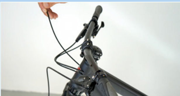
Illustration 190 : Accrocher le capuchon d'extrémité
