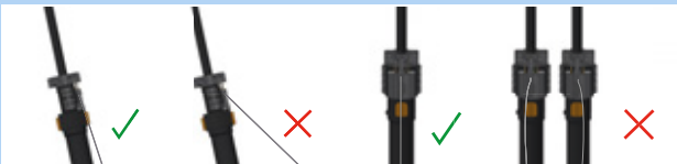
Illustration 158 : Câble Bowden correct et incorrect
