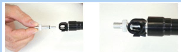
Illustration 148 : Visser l'adaptateur de valve
