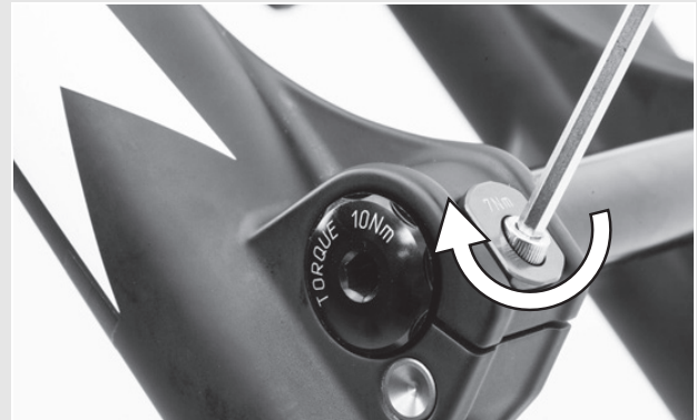
Abbildung 31: Achse anziehen
