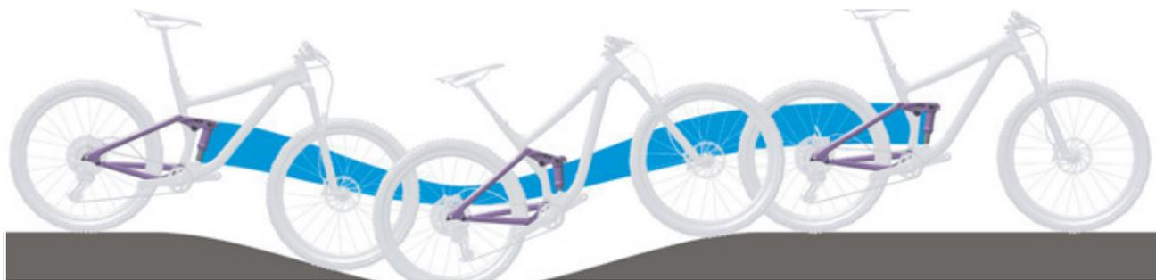
Illustration 235 : Suspension trop souple de l'amortisseur arrière dans les côtes
