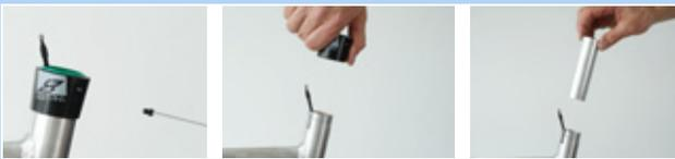
Illustration 167 : Démonter l'enveloppe extérieure et la douille de glissement
