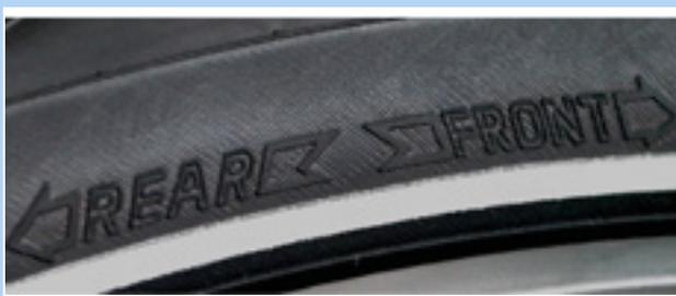
Illustration 54 : Flèche directionnelle sur les pneus VTT
