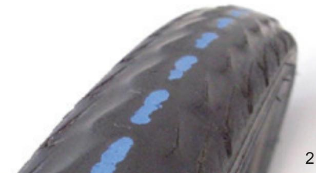
Illustration 146 : Pneu sans profil pouvant encore être utilisé (1) et pneu avec bande de protection visible (2) devant être changé
