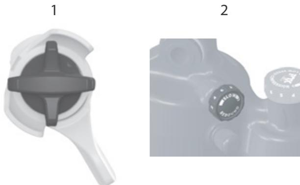
Illustration 234 : Dispositif de réglage de détente Float DPS (1) et Float X (2)
