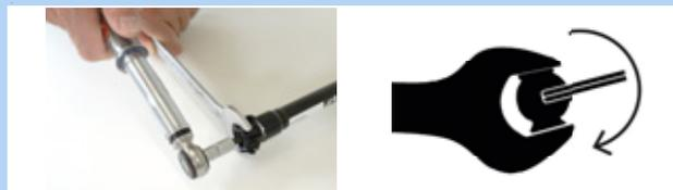
Illustration 181 : Régler dans le sens des aiguilles d'une montre
