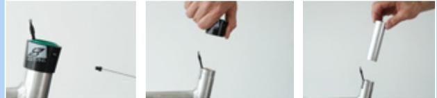
Illustration 201 : Démonter l'enveloppe extérieure et la douille de glissement
