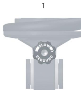
Illustration 95 : Dispositif de réglage de la détente du Float DHX (1)
