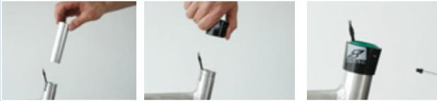
Illustration 183 : Monter la douille de glissement et l'enveloppe extérieure
