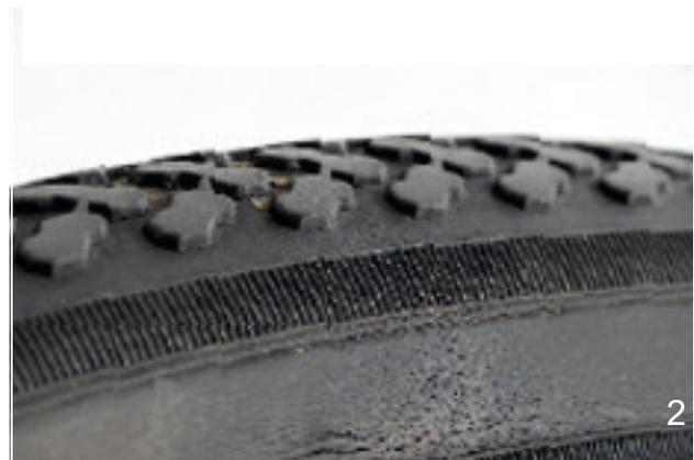
Illustration 147 : Exemples de fissures de fatigue (1) et de fissures d'âge (2)
