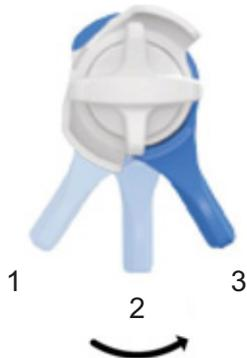
Illustration 89 : Réglage du levier à 3 positions : fermé (1), moyen (2) et ouvert (3)
