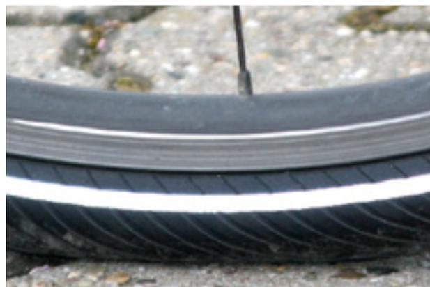
Illustration 82 : Pression correcte. Le pneu se déforme à peine sous le poids du corps
