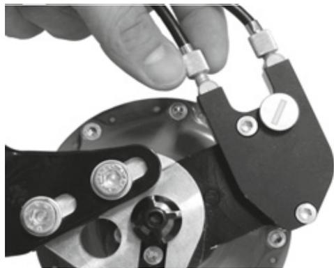
Illustration 152 : Sur les versions de moyeux ROHLOFF avec commande externe du changement de vitesse, le dispositif de réglage de la tension est situé sur le boîtier de câbles qui est placé sur le côté gauche.
