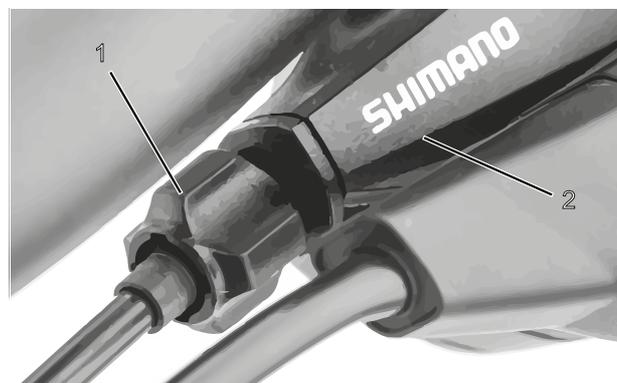
Illustration 153 : Douille de réglage (1) du changement de vitesse à un câble actionné par câble avec boîtier de manette de vitesse (2), exemple
