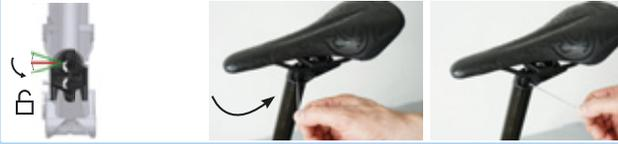
Illustration 159 : Placer le mécanisme de réglage de la hauteur en « position ouverte »
