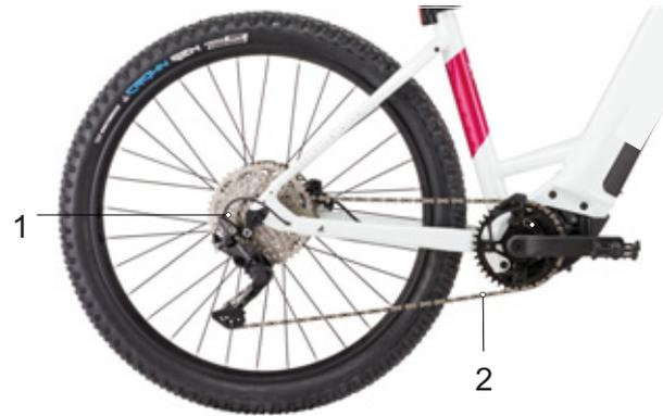
Illustration 33 : Schéma de l'entraînement à chaîne avec dérailleur
