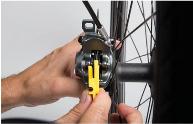
Illustration 148 : Contrôler la plaquette de frein montée à l'aide de la cale de transport
