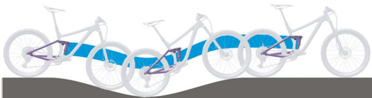
Illustration 17 : Comportement optimal de l'amortisseur arrière en terrain vallonné
