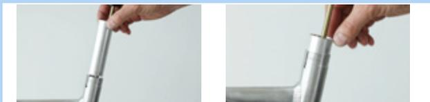
Illustration 190 : Insérer le tube de la douille de glissement dans le tube de selle
