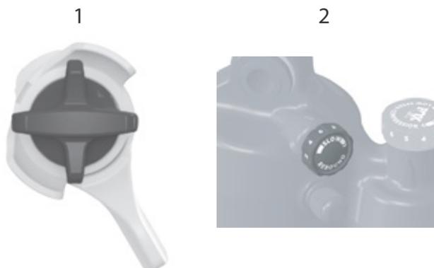
Illustration 94 : Dispositif de réglage de détente Float DPS (1) et Float X (2)
