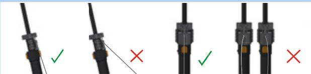
Illustration 186 : Câble Bowden correct et incorrect
