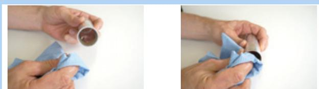
Illustration 174 : Nettoyer le tube de la douille de glissement
